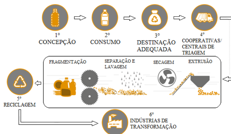
Figura 12 - Fluxograma da cadeia produtiva do seguimento de reciclagem de material plástico.
