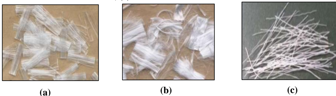
Figura 8 - Fibras poliméricas. (a) Microfibras multifilamentadas; (b) Microfibras monofilamentadas; (c) Macrofibras monofilamentadas.
